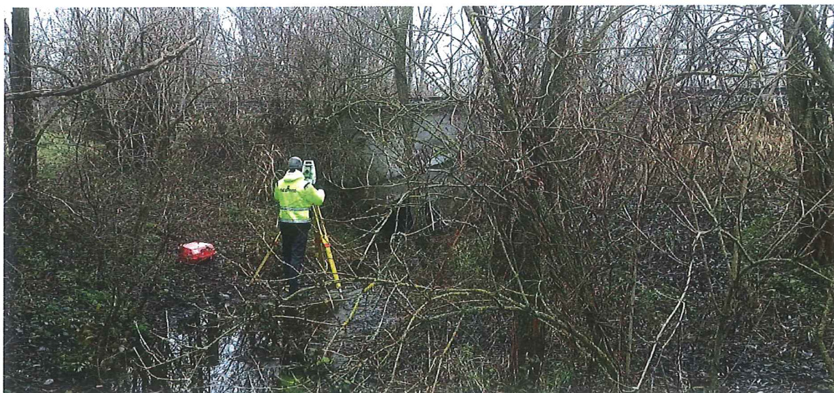
Geodetické zameranie skutkového stavu priepustu
